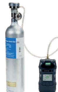
Comprobación manual con gas patrón
